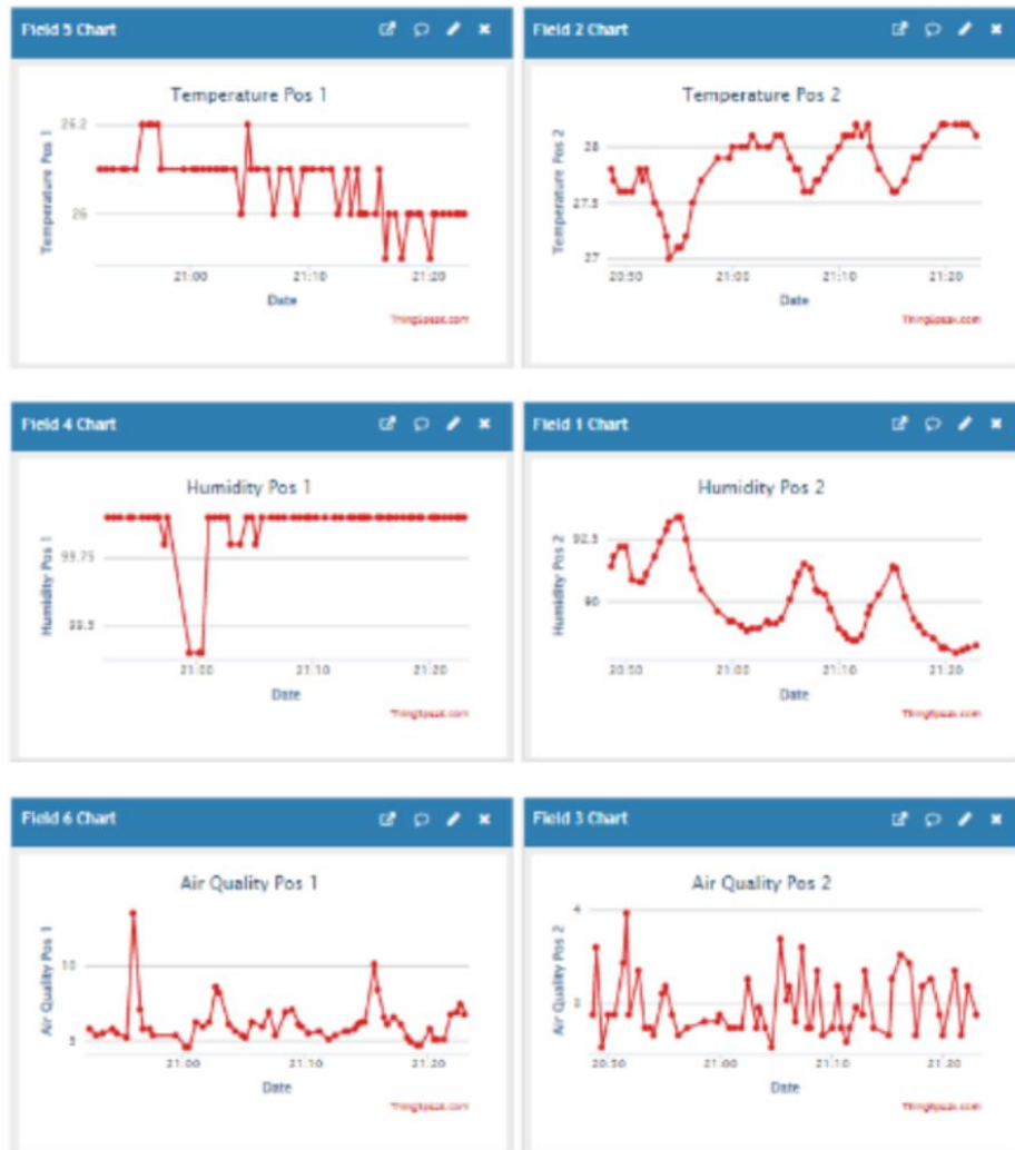
شكل (4): رسم بياني لـ ThingSpeak يوضح بيانات درجة الحرارة والرطوبة وجودة الهواء (Waworundeng, 2024).
